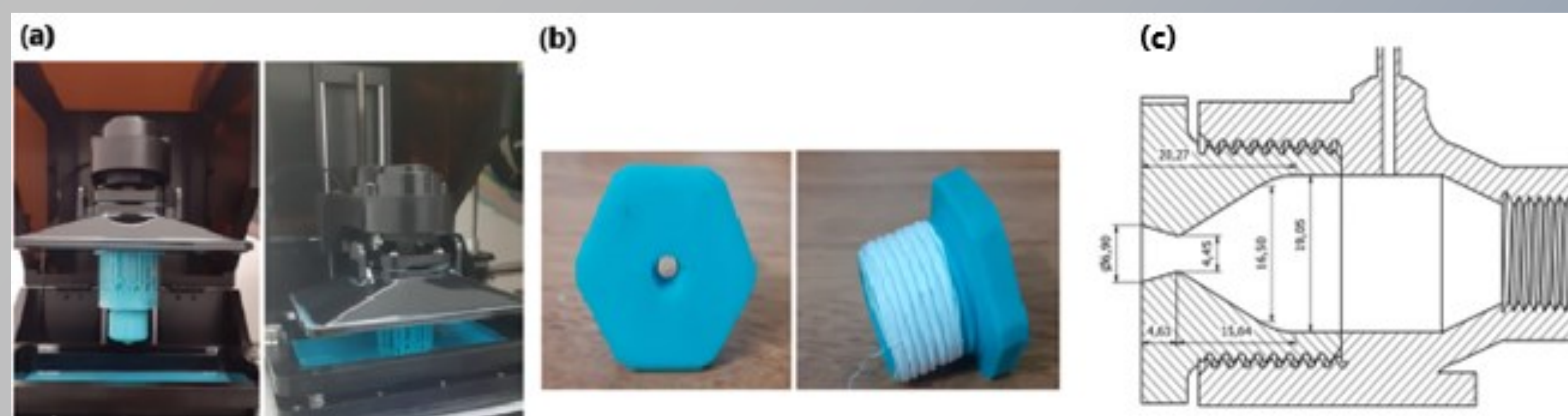
Figura 3. (a) Impresora 3d de resina (SLA). (b) Tobera física ya ensayada, vistas frontal y lateral. (c) Vista en corte de tobera y banco.
